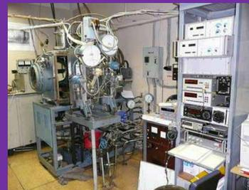
**Тепловые испытания охлаждаемых модулей ИТЭР, КПС, >10-20 MWт/м2**
