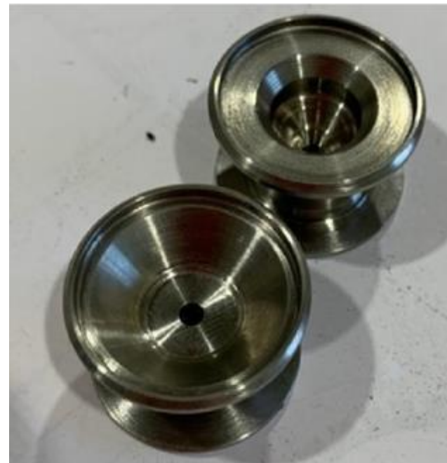
Экспериментальные образцы смесительного элемента водородно- воздушного генератора газа
