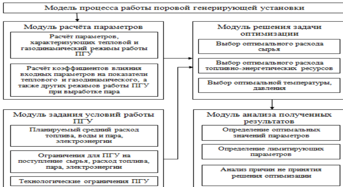
Рис. 2 Структура модели оптимизации управления распределением сырьевых и топливно-энергетических ресурсов при работе ПГУ
