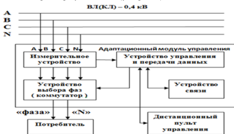
Схема адапционного модуля управления энергоснабжением потребителя
