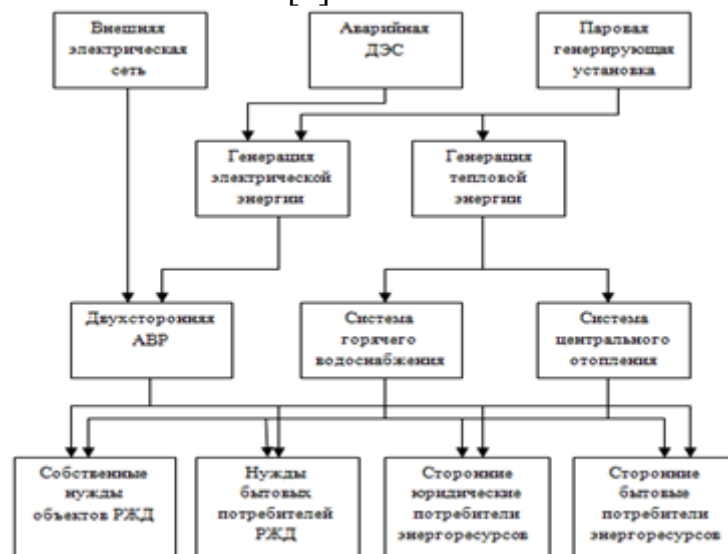
Рис. 1 Схема гарантированного энергоснабжения инфраструктуры удалённого объекта на основе паровой генерирующей установки
