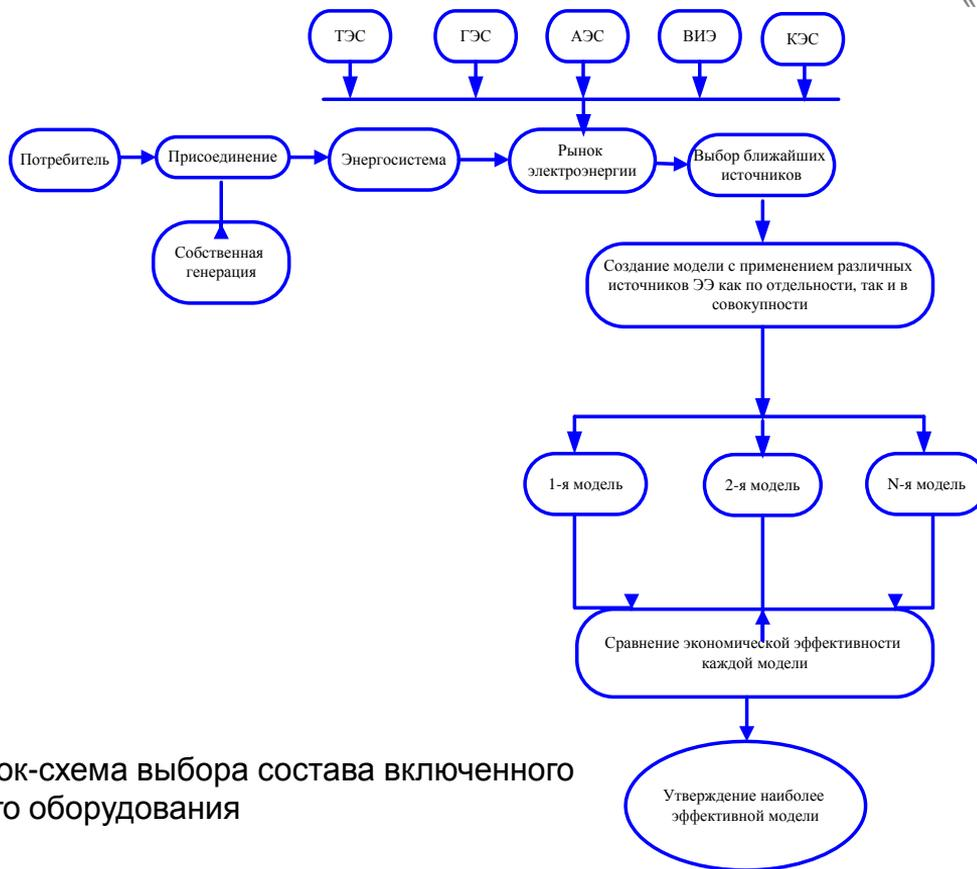
Рисунок 1. Блок-схема выбора состава включенного генерирующего оборудования
