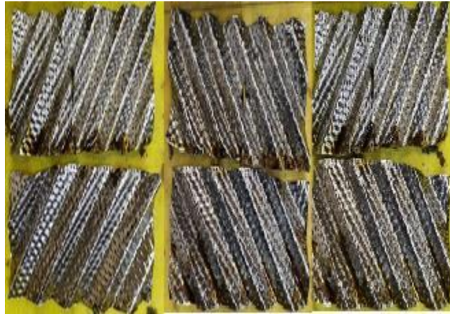
Рис. 3 – Сепарационные элементы: гофрированные пластины с различной ориентацией гофр, выполненных под различными углами – 45° или 135° и перекрестные гофрированные пластины
